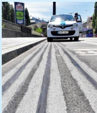
ParkHere: Die Sensoren sind im Asphalt installiert.
